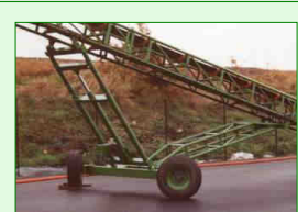
Palée en vé avec roues d'orientation Inclinaison réglable par vérin hydraulique et pompe manuelle
